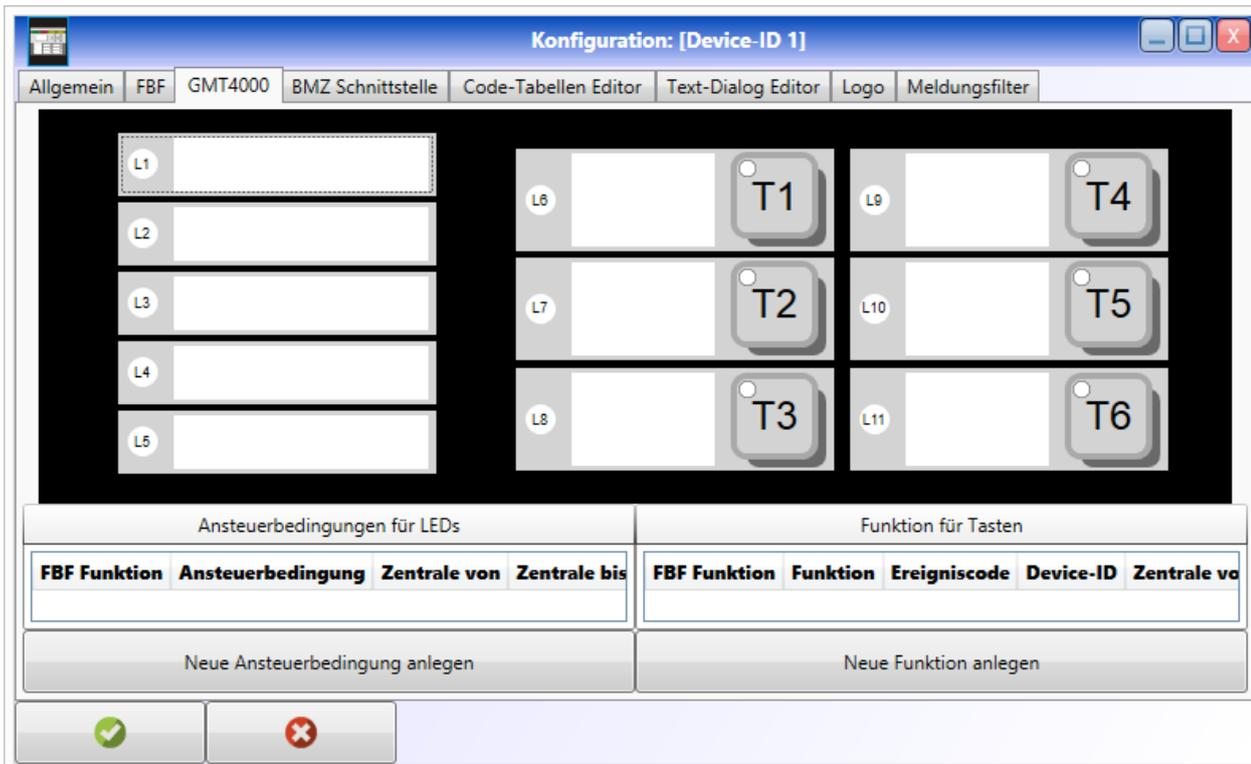
Unter dem Tab GMT4000 werden Ansteuerbedingungen für LEDs und Bedienungen (Funktion für Tasten) neu angelegt / bearbeitet.
